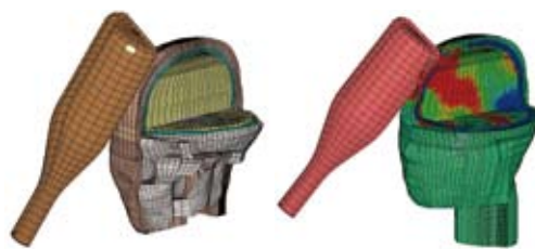
左：一升瓶で前頭部を強打された際の3次元頭部有限要素モデル 右：脳内圧力分布（赤：圧縮、青：引張）の解析結果
