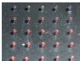
2つのインクジェットにより、極 微量の試薬を混合希釈したところ
