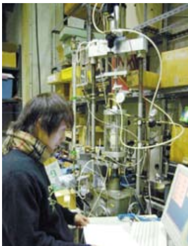
三軸圧縮試験（砂の液状化試験）
