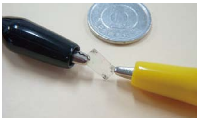
噴霧装置を使用し、透明導電膜をコーティングした実験用プレパレート
