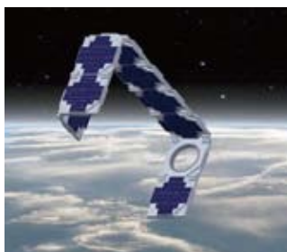
オープンモジュラー型アーキテクチャ のパネル展開型超小型衛星 （画像提供：東大阪宇宙開発協同組合）
