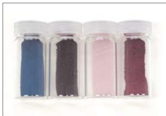
金ナノ粒子の寸法、形状、担体物質の誘電率などによる色調の変化
