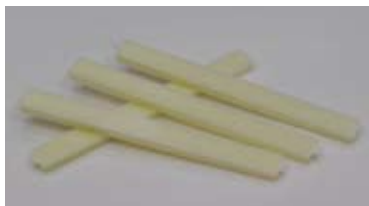
フィラーにB型リン酸カルシウムを用いた、完全生体吸収性複合材料
