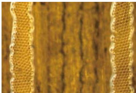
ポリスチレン微粒子が作る自己組織構造を、磁場を使ってパターン化
