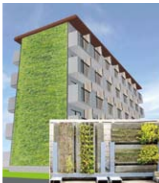
集合住宅の緑化シミュレーション結果。写真右下は、壁面緑化パネルの実験結果
