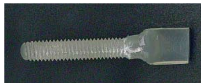
鍛造法により試作した生体吸収性プラスチック製スクリュー
