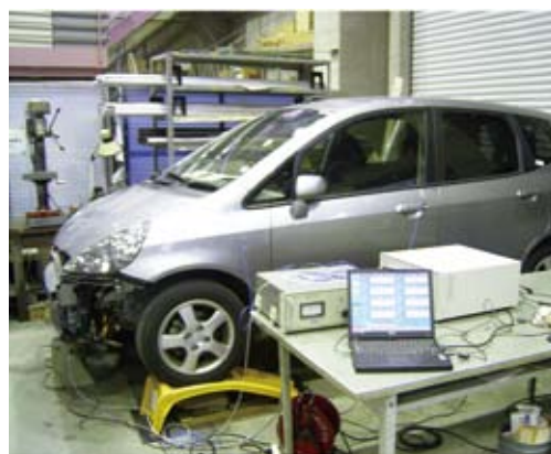
加振機を用いて行う車体加振実験の例
