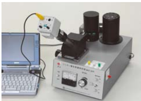
高勾配磁場下での微粒子の運動の観察
