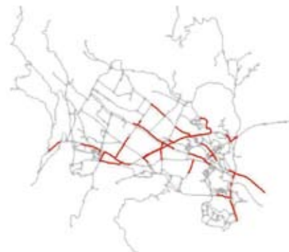
交通流シミュレーションによる交通渋滞発生状況
