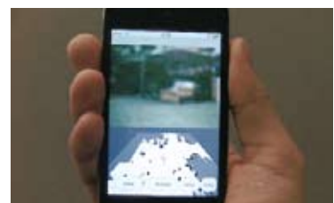
iPhoneを用いたロボットの遠隔操作：遠隔地の画像転送と地図の自動生成
