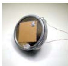
Φ10mm程度の金属材料マイクロポンプの試作品
