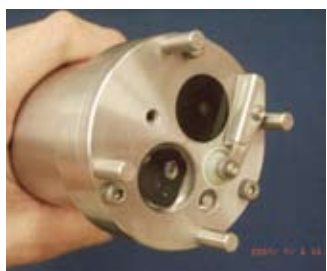
横山勝英准教授が開発に携わった「新型中・高濃度濁度計」
