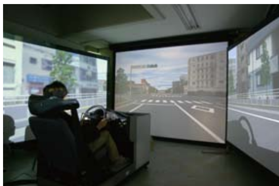
ドライビングシミュレータを用いた標識の効果評価
