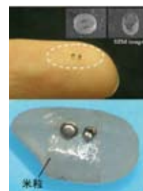
直径500μmの金属マイクロ深絞りカップ
