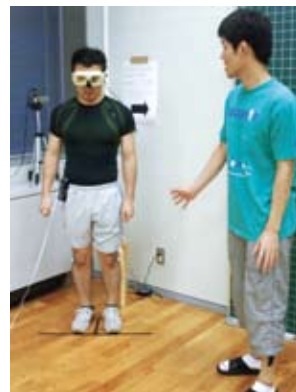
視線解析装置（アイマークレコーダ）を使い、被験者の視線の動向を検証する
