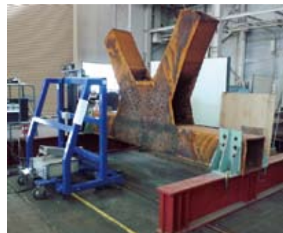
トラス橋格点部の計測状況
