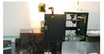
写真4 円形対象物の傷検査装置
