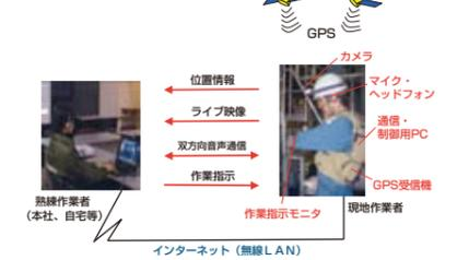
写真2 遠隔作業訓練システム
