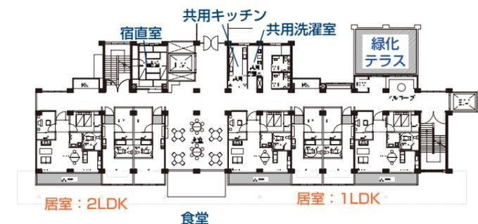
学校建築の高齢者住宅へのコンバージョン：多摩ニュータウン：上野研究室基本設計2005
