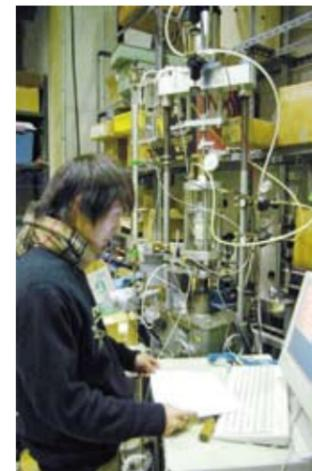
三軸圧縮試験（砂の液状化試験）
