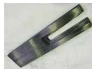
コの字型積層 CFRP 板
