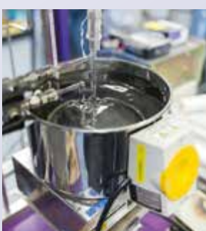
CO酸化反応実験：ガラス管に触媒試料を入れ恒温水槽に浸す。
